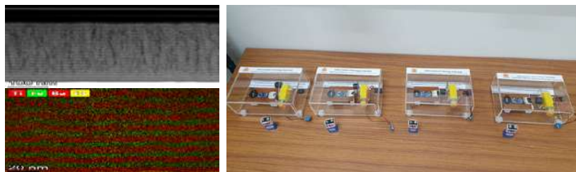
मजबूत इलेक्ट्रोमैकेनिकल कपलिंग के लिए इष्टतम स्ट्रेन ग्रेडिपेंट के साथ बीसीजेडटी/सीएफओ पॉलीक्रिस्टलाइन सुपरलैटिस संरचनाएं - मार्च 2024 में IITH-DRDO पेटेंट प्रदान किया गया।
